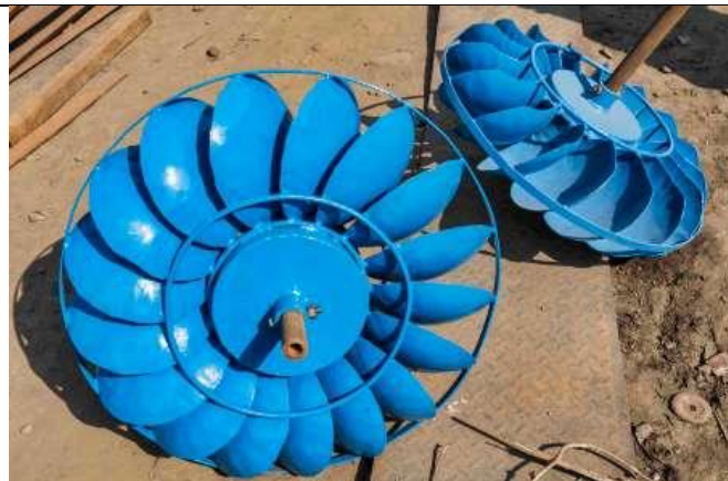
Die neue Metall-Turbine, die bis zu 3-mal schneller dreht und mahlt als die Holzrad-Wassermühle.
