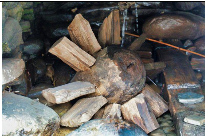
Beispiel einer traditionellen Holzrad-Wassermühle, die sehr ineffizient ist und alle 1-2 Jahre ersetzt werden muss.
